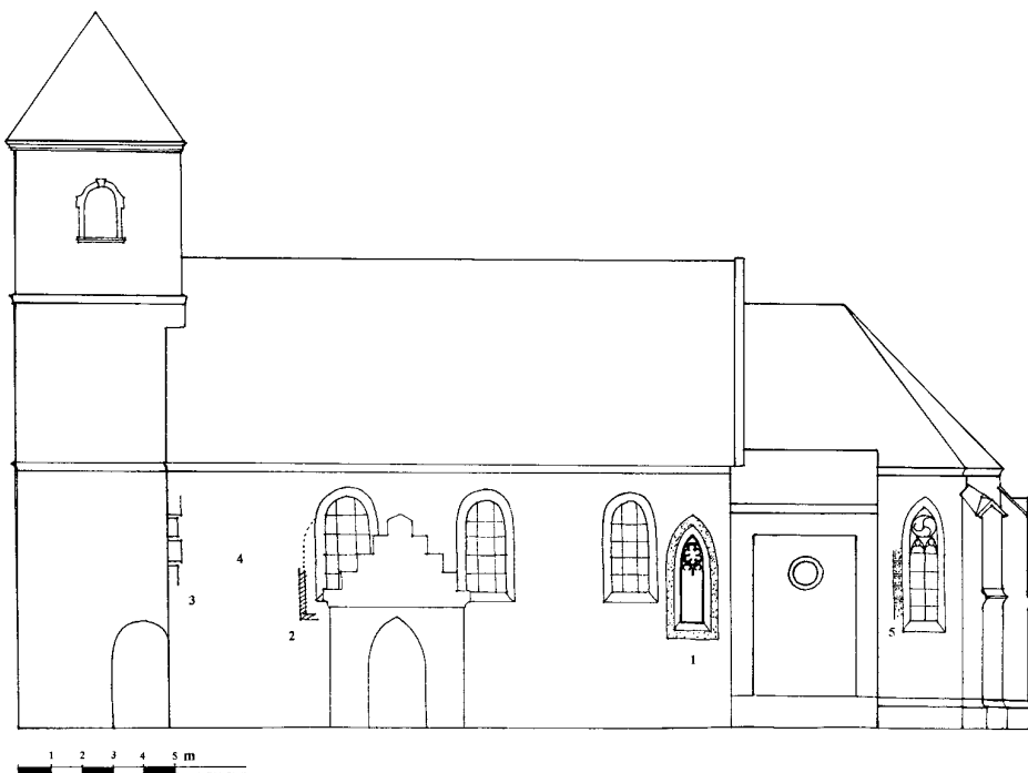
Obr. 5: Orientační náčrt jižní strany lodi a presbyteria s vyznačením polohy nejškodlivějších nálezů. 1 - odhalené gotické okno; 2 - průzkumem zachycený pozůstatek původního gotického okna, část ostění; 3 - iluzivní malované armování nároží, goticko renesanční fáze stavby; 4 - poloha umístění malovaných barokních slunečních hodin; 5 - nález malované bosované pasparty, goticko renesanční fáze stavby. (Kresba K. Foud, 1995.)
